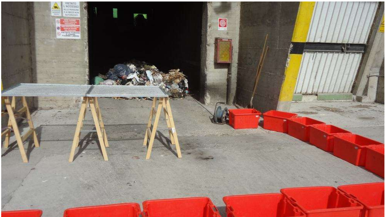
Fermo ASITE, 11/09/2013: griglia utilizzata come vaglio
