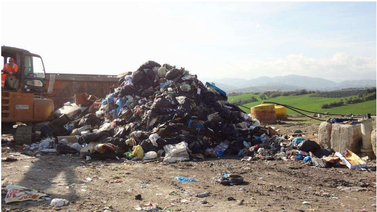
Corinaldo, 28/10/2013: campione da sottoporre a quartatura.
