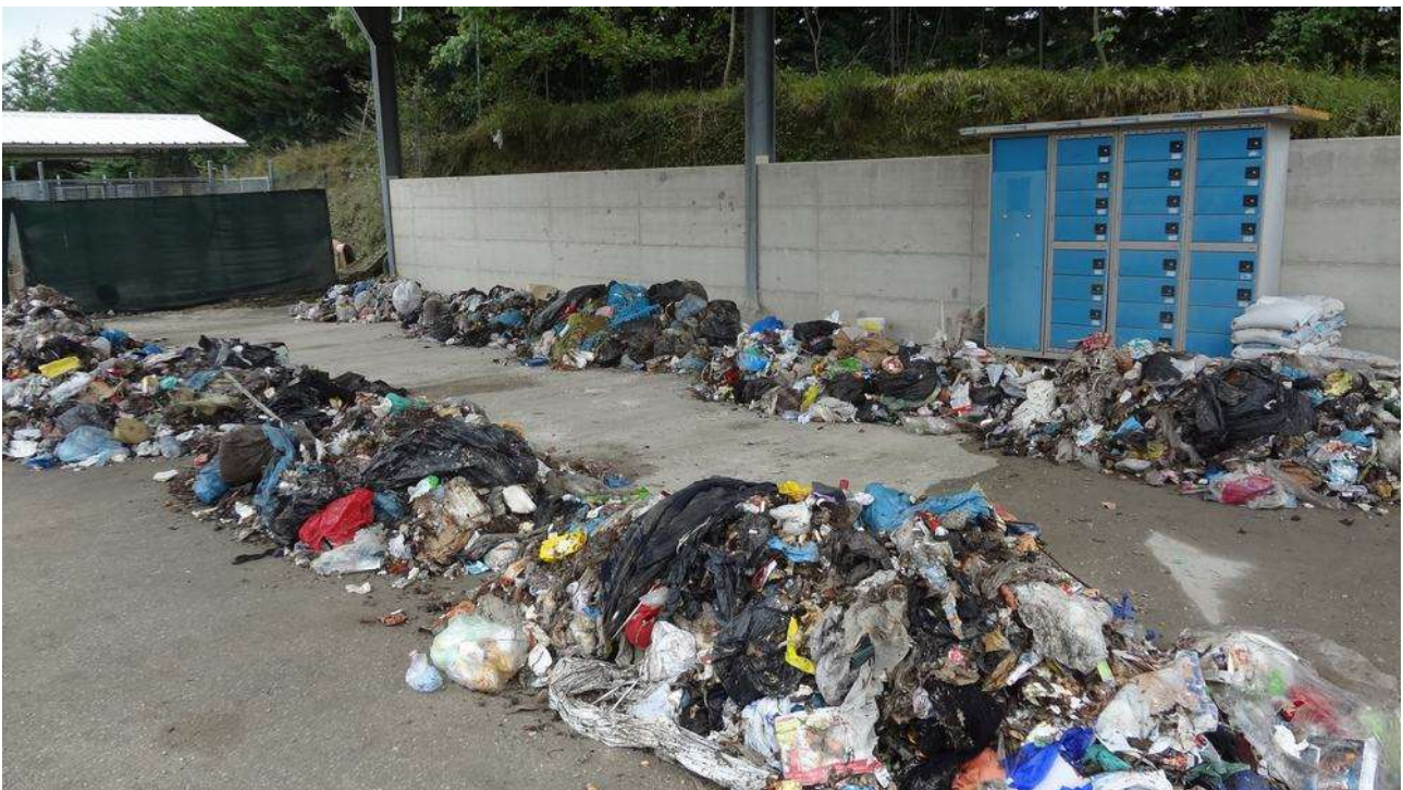
Urbino 09/10/2013: campione da sottoporre a quartatura: ogni cumulo proviene da uno dei diversi comuni indicati.
