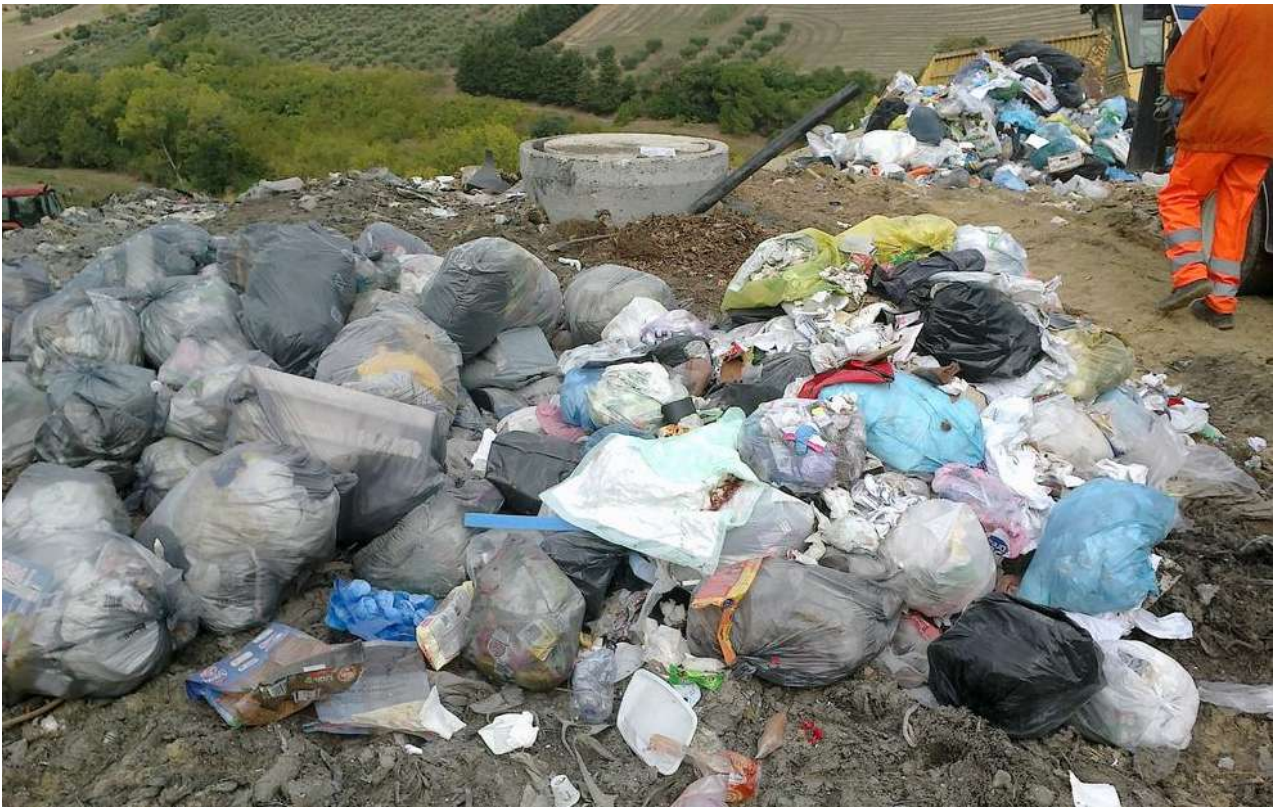
Porto Sant'Elpidio 04/10/2013: campione da sottoporre a quartatura
