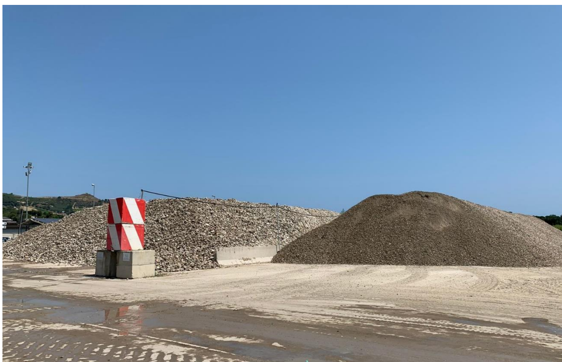
Figura 4: cumuli di prodotti in uscita. A sinistra il pietrisco riciclato e a destra la sabbia riciclata.
