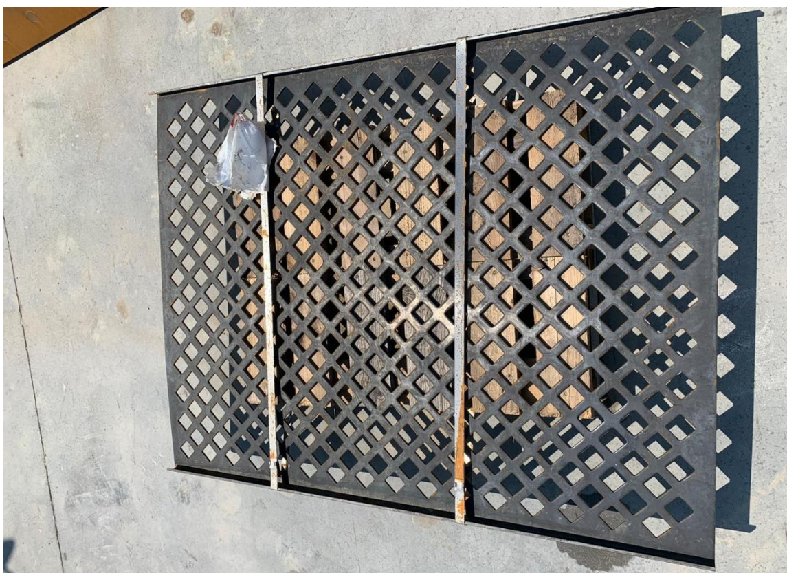
Figura 2: griglia quadrata per la separazione degli aggregati in base alle dimensioni.
