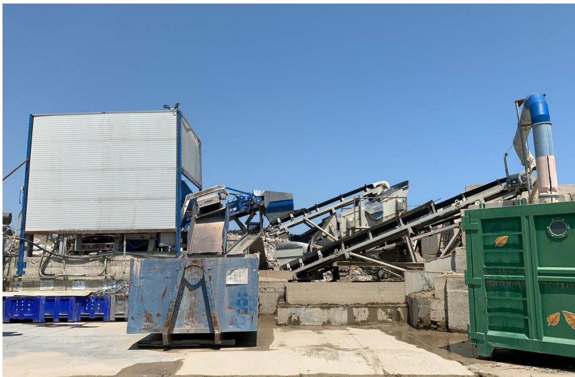
Figura 1: macchinario di triturazione dei materiali.
