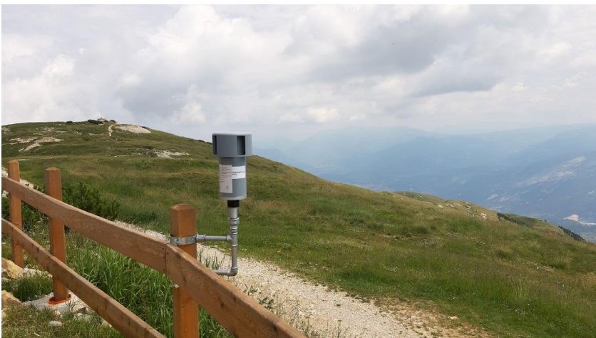
Esempio di campionario aerobiologico Sigma-2 in alta quota (Monte Altissimo)
